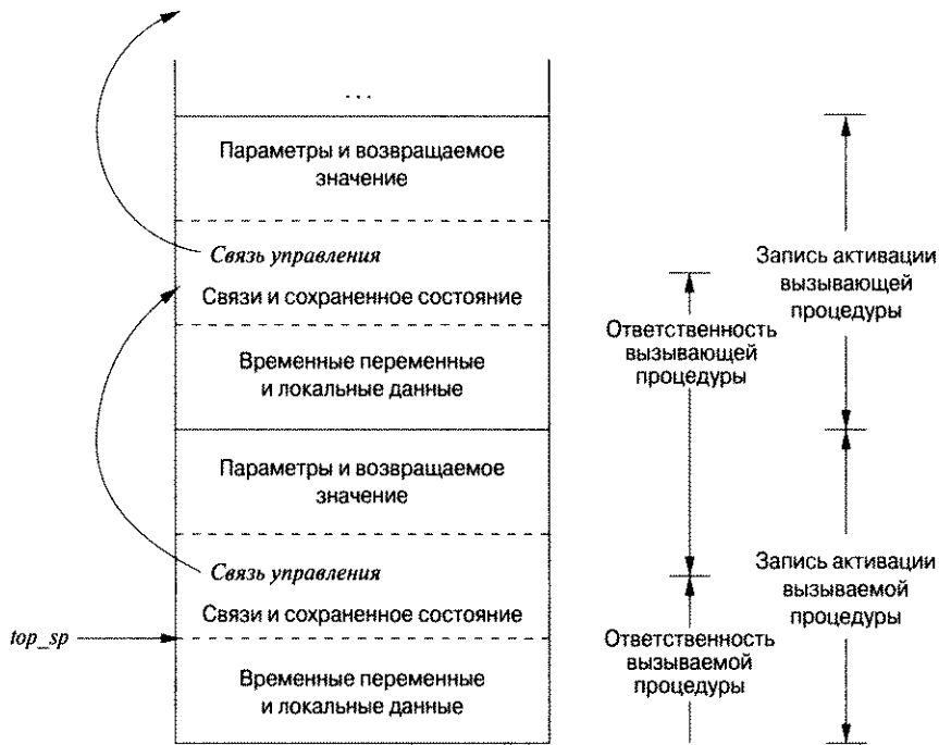
Рис. 7.7. Разделение задач между вызывающей и вызываемой процедурами
